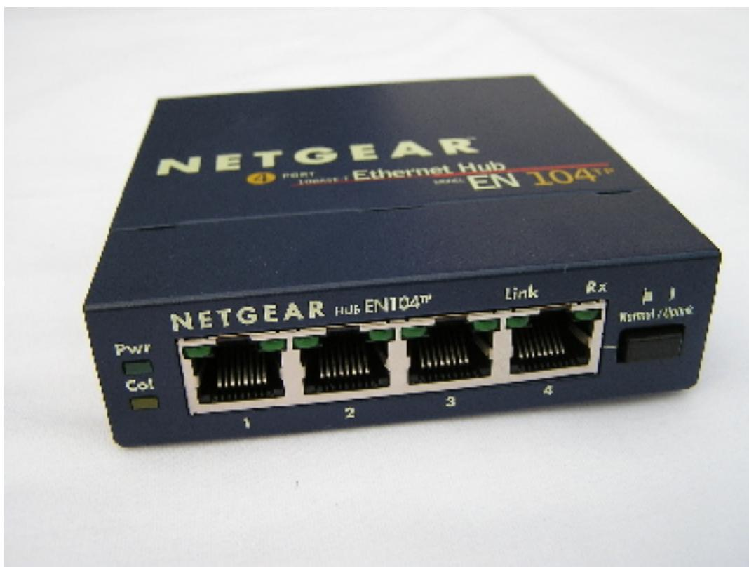
**Aktivnu** komunikacijsku opremu sačinjavaju uređaju koji koriste izvor električne energije i koji omogućuju aktivno upravljanje mrežnim prometom. Zajednička im je značajka da imaju procesor i memoriju. Na osnovu svojih značajki, namjene, operativnog sustava i ugrađenih programa donose odluku o putanji mrežnog prometa kojeg generiraju ili koji kroz njih prolazi.
