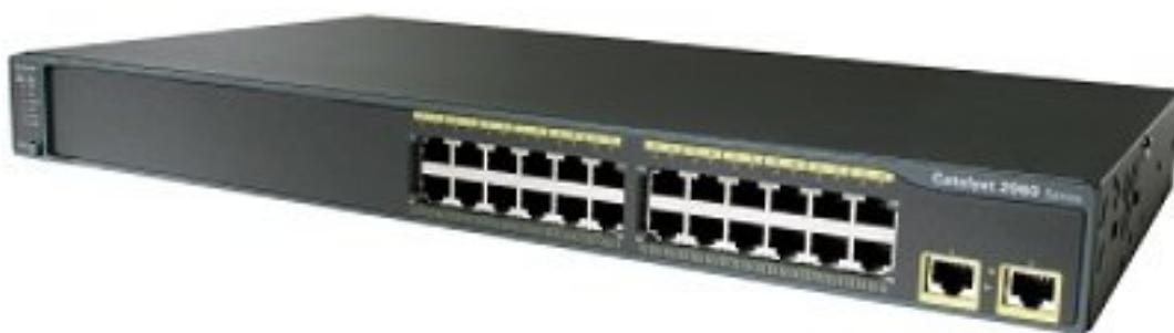
Switchovi omogućuju *full-duplex* način komunikacije. Kod *full-duplex* načina rada oba uređaja koji komuniciraju mogu slati i primati podatke istovremeno, a da se ne dogodi kolizija.
