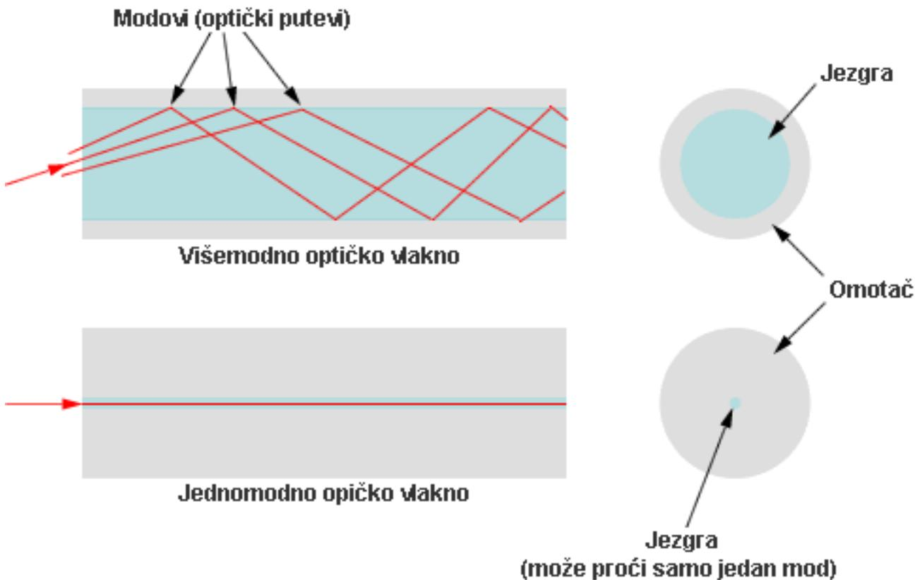
**Jednomodno optičko vlakno** kroz jezgru propušta samo jednu zraku svjetlosti. Kao izvor svjetla koristi se laser, što značajno povećava brzinu prijenosa podataka te udaljenost na koju se mogu prenijeti.
