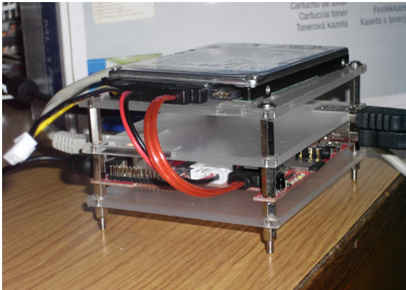
Na gornjoj plastičnoj ploči na kojoj leži tvrdi disk postoje rupe kroz koje možemo vijcima pričvrstiti tvrdi disk za Cubieboard kućište.
