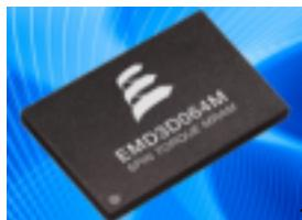
Tvrta Everspin Technologies najavila je da će na tržište izbaciti novi tip memorije, ST-MRAM ([Spin-Torque Magnetoresistive RAM](#) [1]). Radi se o *non-volatile* memoriji, što znači da zapis ostaje sačuvan i nakon prestanka napajanja.
